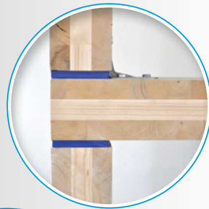
Gemessener Aufbau - mit Winkelverbinder und Schrauben
