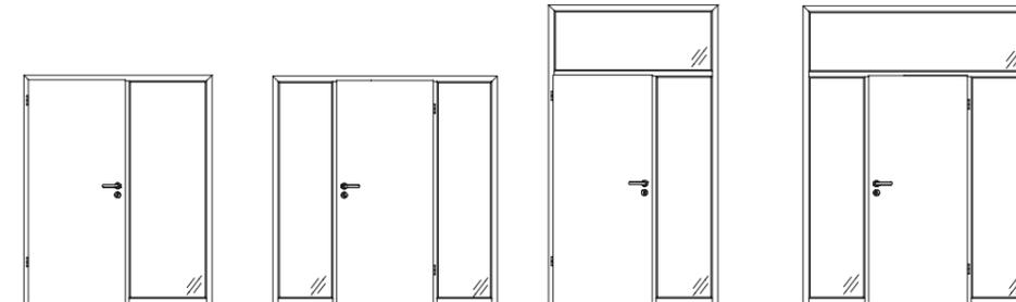
SÜHAC Windfangelemente erhalten Sie für eine Kombination mit Dreh- & Schiebetüren und in den Ausführungen als Futter oder Blockrahmen
