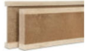
Stegträger bestehend aus Obergurt und Untergurt – die mit einer 6,5 mm Hartfaserplatte verbunden/verleimt sind. Als Variante mit ausgedämmten Steg.
