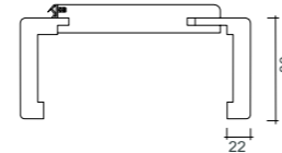
Futter Rundform (RF), Bekleidungsbreite 80 mm
