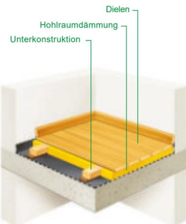
Dielenboden auf Stahlbetonplatte
