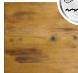
**Gehackte Oberfläche:** Eine gehobelte Oberfläche wird mit wenigen Messern sehr flach und langsam bearbeitet. Das gleiche Prinzip wendeten Zimmerer schon vor Jahrtausenden an, um Balken zu behauen. Hierdurch entsteht eine außerordentlich interessante Holzoberfläche.
