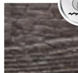
**Karbonisierte Oberfläche:** Durch kontrolliertes Beflammen entsteht eine Holzkohleschicht mit sehr interessanter und lebhafter Optik, die je nach Holzart unterschiedlich ausfällt.
