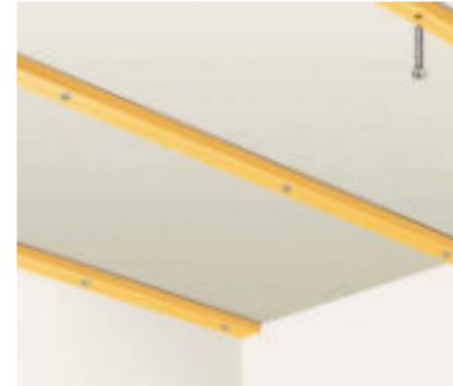
01 Zur Befestigung der Vollholzprofile werden Latten als Unterkonstruktion an die Decke gedübelt. Eventuelle Unebenheiten sind mit Keilen auszugleichen. Der Abstand zwischen den Latten darf maximal 50-60 cm betragen!
