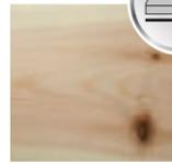
**Gehobelte Oberfläche:** Aufrotierenden Walzen sorgen präzise eingestellte Hobelmesser aus Spezialstählen dafür, dass eine absolut gerade und glatte Oberfläche in der gewünschten Form entsteht.
