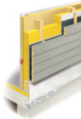
Wandaufbau der Holzskelettbauweise.
