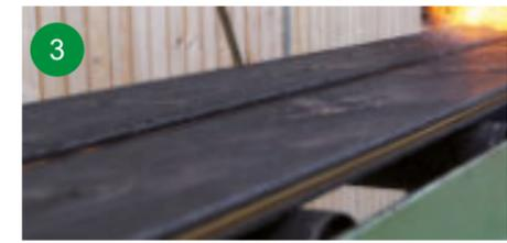
3 Nach der Beflammung können verschiedene Bearbeitungen folgen. So prägen das Abbürsten, das Oberflächen-Coating gegen Abfärben oder die Veredelung mit nussbaumfarbener Holzlasur zusätzlich das Erscheinungsbild der Profile.
