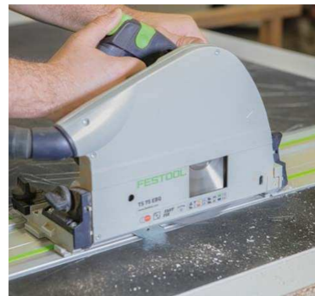
Zuschnitt mit Handkreissäge und Führungsschiene
